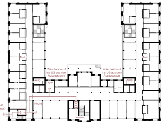
Warenanlieferung / Entsorgungswege vom Haus 25
